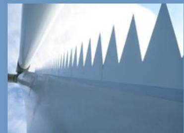
Inspirées par la forme des ailes des rapaces, les serrations sont un dispositif technologique équipant les pales d'éolienne. Ces dents de scie fixées sur le bord fuyant des pales adoucissent leur pénétration dans l'air et réduisent notablement les turbulences et la puissance sonore.
